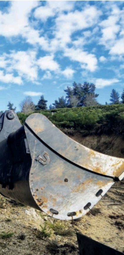
Le montage choisi est en double attache hydraulique, permettant de détacher facilement les équipements et le tiltrotateur afin de travailler en BRH.
